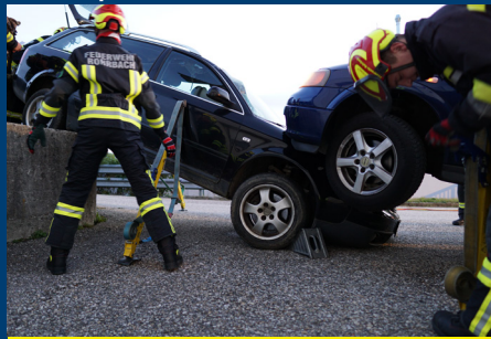
Sichern und stabilisieren der Unfallautos
